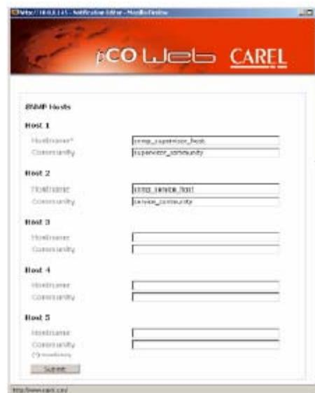
Рис. 4.o – Конфигурация хостов SNMP для отправки сообщений «TRAP»
