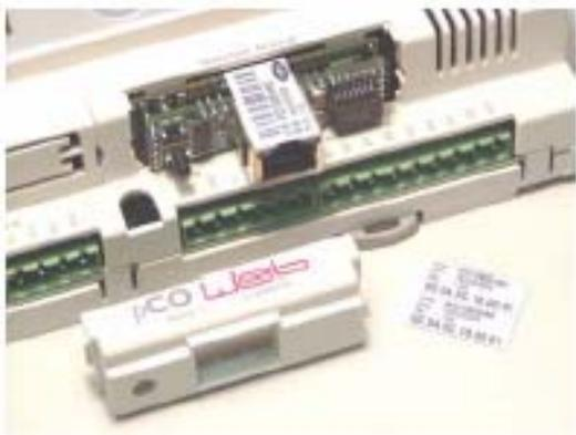
Рис. 2.c — Вставка устройства *pCOWeb* в контроллер *pCO*
