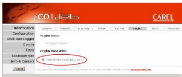
Рис. 8.o – Страница «Plugin»: Устройство *pCOWeb* обнаружило один или несколько устанавливаемых модулей Plugin
