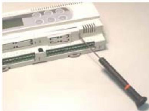
Рис. 2.b — Удаление крышки с контроллера *pCO*
