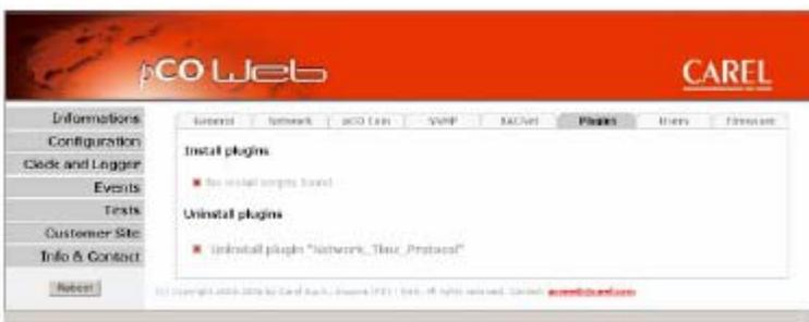
Рис. 8.u – Страница «Install/Uninstall Plugin» после завершения установки модуля «NTP»
