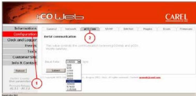
Рис. 8.1 – Установка скорости передачи *pCOWeb-pCO*
