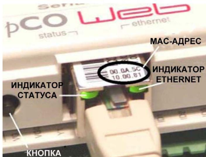
Рис. 1.b — MAC-адрес и светодиодные индикаторы
