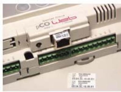
Рис. 2.d — Закрепление устройство *pCOWeb* с помощью крышки
